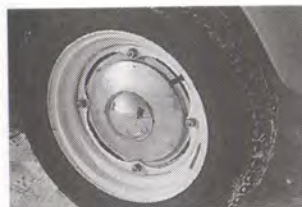
Nix Fiat: Große ATE-Alu-Trommelbremsen verzögerten die Rennsemmel aus dem Alpenland.
