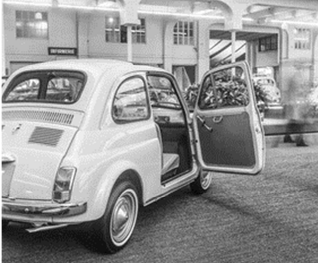
Fiat 500 (1965) - nun mit vorne angeschlagenen Türen, um den Gesetzen in Exportländern Rechnung zu tragen - Genfer Automobilsalon 1965
