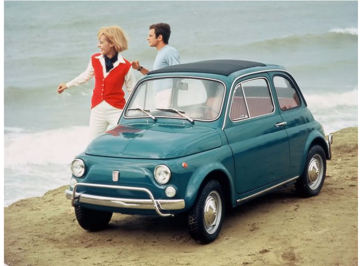
Fiat 500 (1965) - nun mit vorne angeschlagenen Türen, um den Gesetzen in Exportländern Rechnung zu tragen - Genfer Automobilsalon 1965
