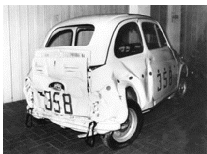
Fiat 500 (1972) - nach einem Heckaufprall mit 80 km/h
