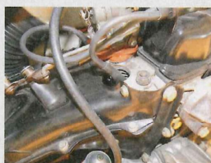
An beiden Zündkabeln fehlen die wichtigen Abdeckgummis
